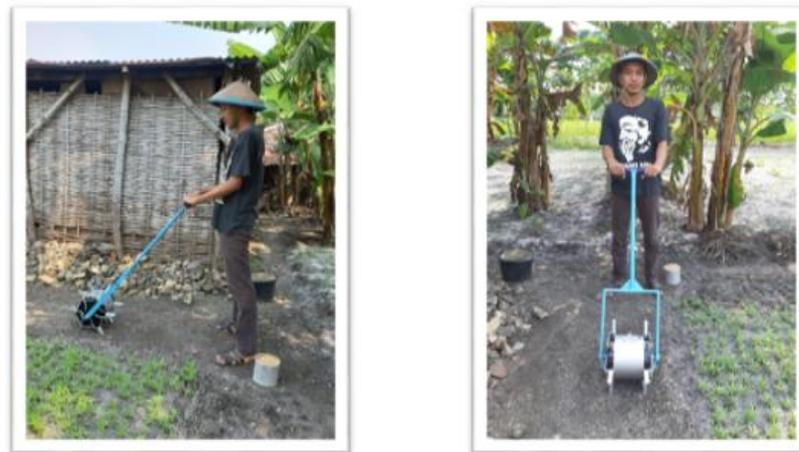
Gambar 6. Alat Tanam Benih Padi Semi Otomatis Hasil Rancangan Saat Digunakan
