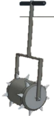
Gambar 5. Desain Alat Tanam Benih Padi Semi Otomatis 3D
